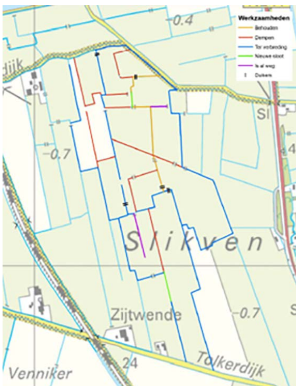
Beeld uit een vergunningaanvraag. De aanvrager wil de rood aangegeven sloten dempen en de sloten in het blauw verbreden.
