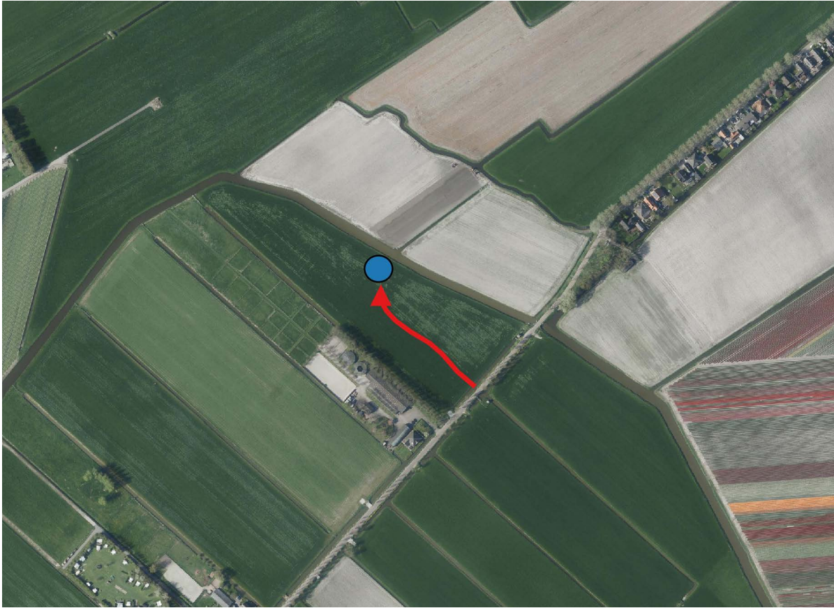
Voorbeeld van een demping van een cultuurhistorisch waardevolle structuur. De aanvrager heeft de sloot gedempt op de plek van de rode pijl. Het betreft een oude molensloot die de voormalige molen van water voorzag. De oude molenplaats is aangegeven met de blauwe cirkel.
