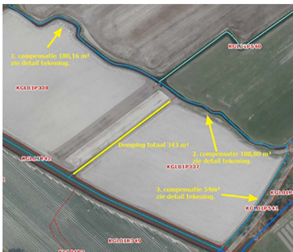
Beeld uit een vergunningaanvraag. De aanvrager wil de sloot op de gele lijn dempen en ter compensatie de kronkelende randen van het perceel afgraven en een sloot verbreden.
